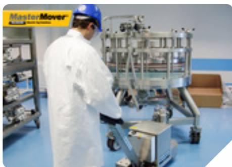
Mașină: MT5/400 Stainless Steel Tipul unității: Sectorul farmaceutic
