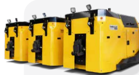
MultiLink Combina le macchine per spostare fino a 300.000kg
